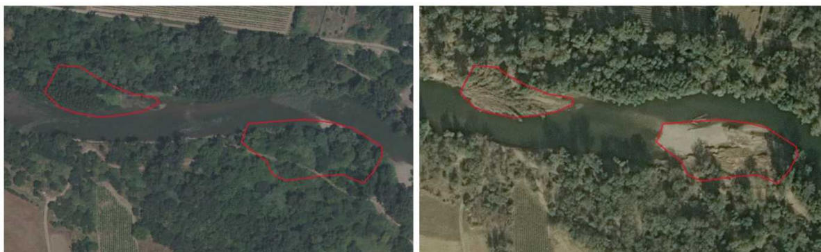
Les embâcles sont bien visibles sur les images Pléiades (document CNES – DDTM de l'Aude)
