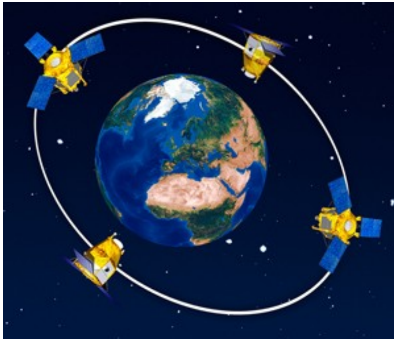
Figure 1: Placés sur la même orbite, les satellites SPOT 6/7 et Pléiades forment une constellation à très haute résolution (50 cm et 1,5 m en panchromatique)
